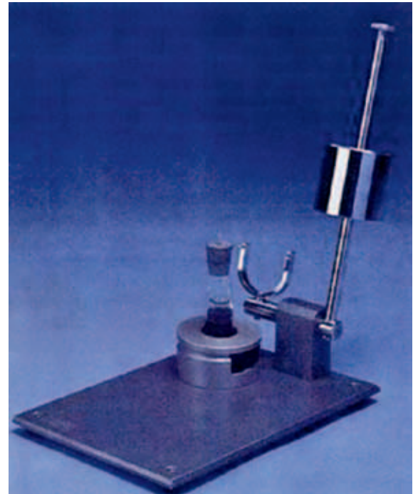
Sedimentkammer nach Sayk
